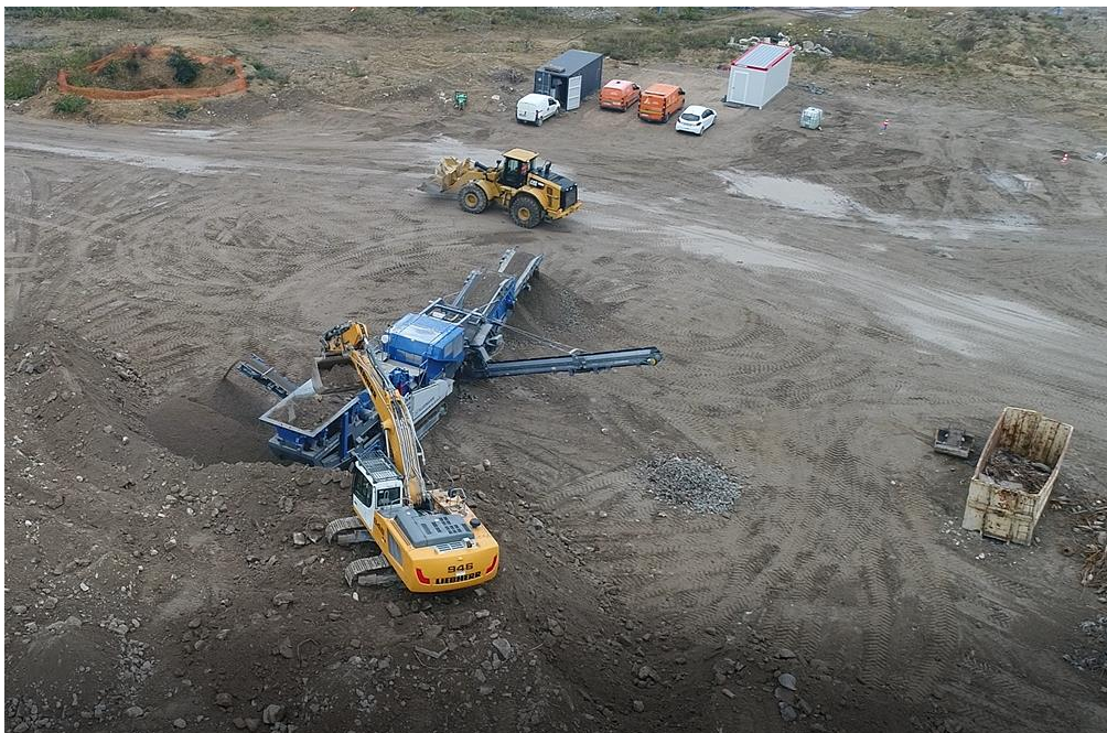
Figure 6 : Atelier de concassage (pelle d'alimentation, concasseur/cribleur, benne à ferraille et chargeuse)
